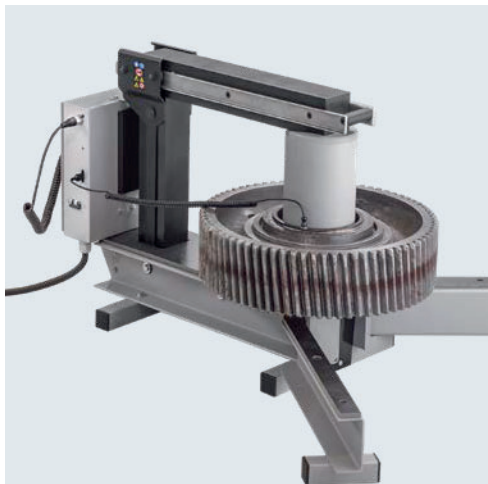
TIH L MB värmer arbetsstycken som inte är lager på upp till 600 kg, beroende på modell.
